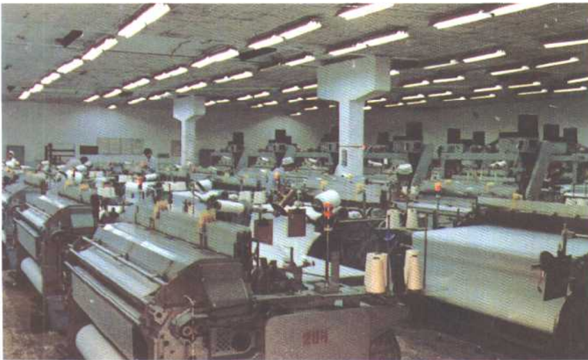
四川第一棉纺织印染厂引进的日本喷水织机(1985 年)
