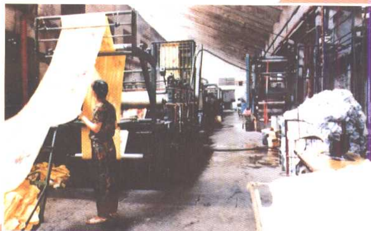
万县市毛巾床单厂的毛巾平幅退浆、 煮练、联合机组(1985 年)
