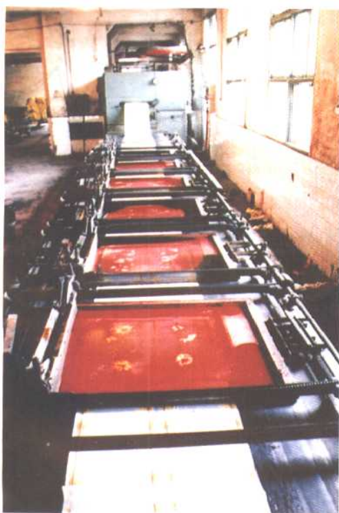
万县市毛巾床单厂的毛巾平网 印花机(1985 年)
