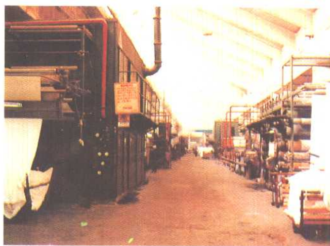
南充印染厂的棉布煮练、漂白、染色、 烘干联合机组
