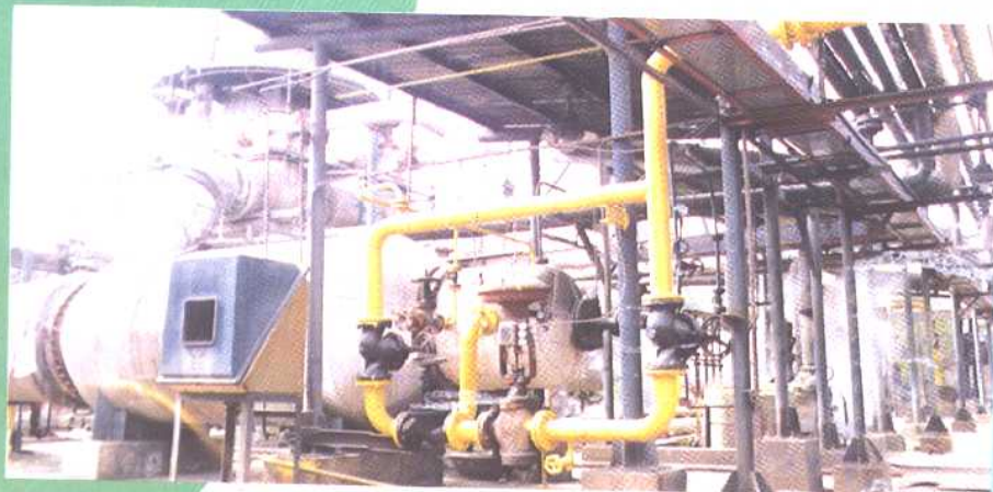
成都化学纤维厂和 成都化工研究所合 作研究的天然气制 造二硫化破装置
