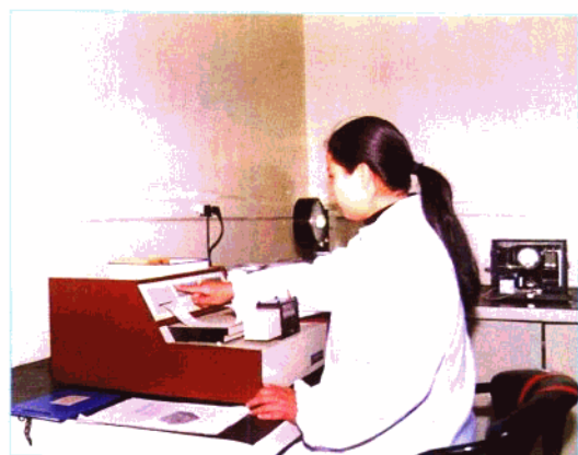
省纤维检验所用长度照影仪检测棉花跨距长度和整齐度
