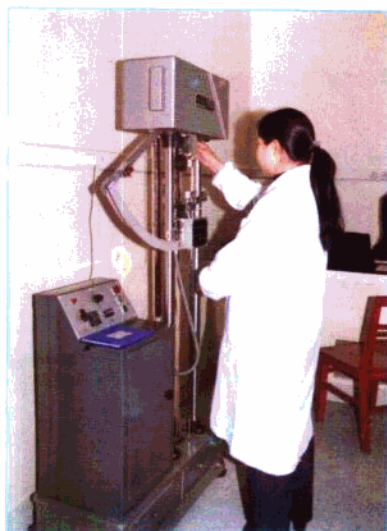
省纤维检验所检验纤维单纱强度
