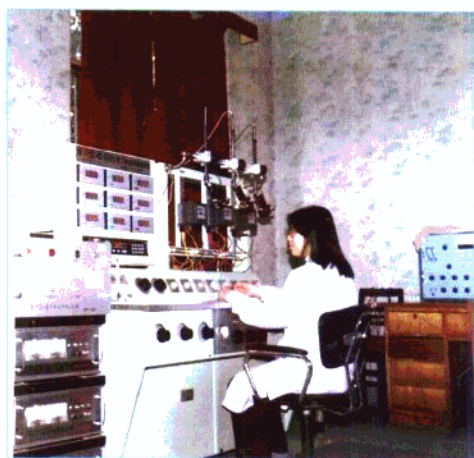
省计量测试研究所校验电能表
