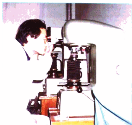
省产品质量检验所检测样坯硬度
