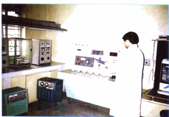
省产品质量监督检验所 1993 年研制的家用电器安全性能测试仪
