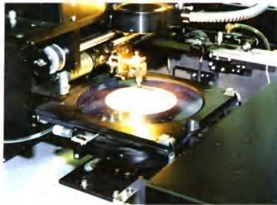
微电子中心 0.8\mu\text{m} CMOS 集成电路芯片制造技术。
