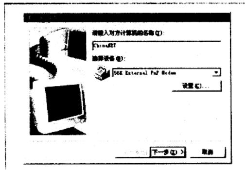
③ 弹出“建立新连接”对话框，如上图所示。在“对方计算机名称”框中输入服务器端计算机的名字，例如“ChinaNET”。单击“下一步”继续。
