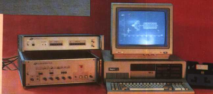
⑭CC5331X型视频自动测试系统
