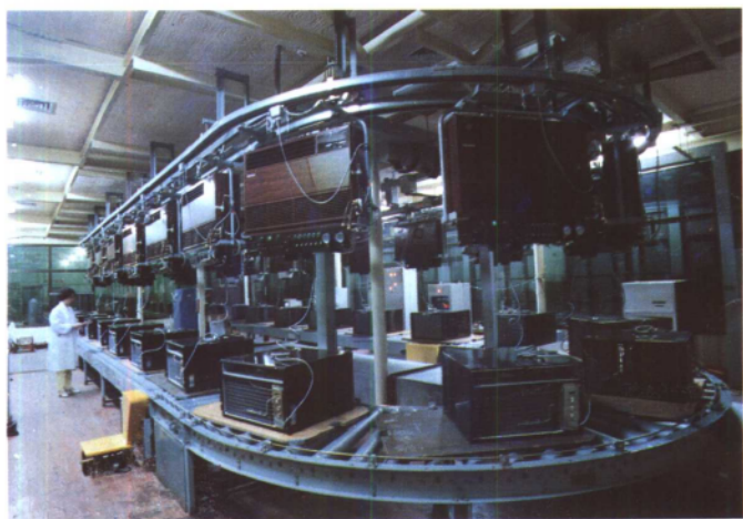
江南牌空调器 总装测试流水线
