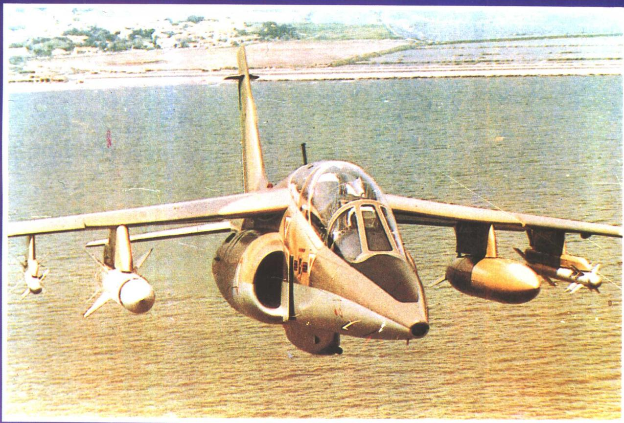
**法、德合作“阿尔法喷气”教练/攻击机** 首飞于1973年。座舱布局为串列双座，机长12.29米，翼展9.11米，机高4.19米，空重3345公斤。最大速度M0.85，最大爬升率57米/秒，实用升限15000米，转场航程2780公里，作战半径540~670公里。主要设备有陀螺平台、微型塔康、甚高频全向无线电指向标/仪表着陆系统/信标机、敌我识别/电码选编识别装置等。武器装备有：1门30毫米机炮，5个外挂点，可挂火箭、各型炸弹、子母弹、空空或空地导弹等。
