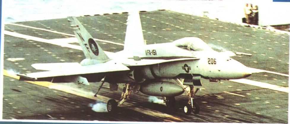
**美国 F/A-18“大黄蜂”战斗攻击机** 美国海军主力舰载机，首飞于1978年。主要执行为航空母舰护航、对地攻击和侦察等任务。乘员1人，机长17.07米，翼展11.43米，机高4.66米，空重10680公斤。最大速度1910公里/小时，爬升率254米/秒，实用升限15240米，航程3700公里，作战半径833公里。主要设备有火控雷达、全天候着舰系统、四余度飞行控制系统等。武器装备有：1门20毫米机炮，9个外挂点，可挂空空导弹、空地（舰）导弹和炸弹等。
