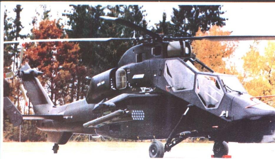
**德、法合作“虎”反坦克直升机** 该机有3个型别：HAP为法国陆军护航和火力支援型，装1门30毫米机炮和4枚空空导弹及2个火箭发射器；PAH-2为德国陆军反坦克型，装8枚反坦克导弹或4枚空空导弹；HAC为法国陆军反坦克型，装8枚反坦克导弹或4枚空空导弹。旋翼直径13米，机长14米，机高3.81米，空重3300公斤，乘员2人。最大速度280公里/小时，爬升率10米/秒，续航时间2小时50分钟。
