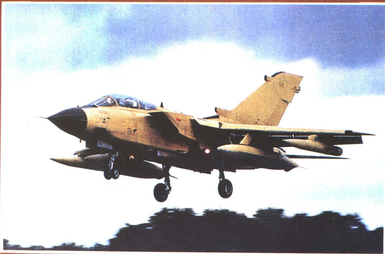
**英、德、意合作“狂风”战斗机** 首飞于1974年，主要任务是攻击地面和海面目标，同时兼顾制空、截击、侦察等任务。乘员2人，机长16.72米，翼展13.91米，机高5.95米，空重14091公斤。最大速度2332公里/小时，实用升限15240米，转场航程3900公里，作战半径833~1390公里。主要设备有多功能脉冲多普勒雷达、地形测绘跟踪雷达与激光测距器等。武器装备有：2门27毫米机炮，8个外挂点，可挂空空、空地、反雷达导弹，以及各种炸弹、核弹等。
