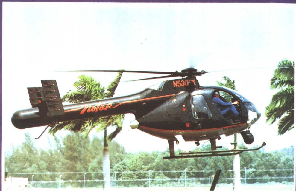
**美国 MD-520 无尾桨直升机** 美国近年研制的新型无尾桨直升机。1989年首次试飞，1991年初开始交付使用。主要执行战场侦察、通讯联络等任务。乘员2人，旋翼直径8.62米，机长9.75米，机高3.11米，空重696公斤。最大速度281公里/小时，爬升率9.25米/秒，实用升限4815米，航程418公里，载油量183公斤，续航时间2.45小时。
