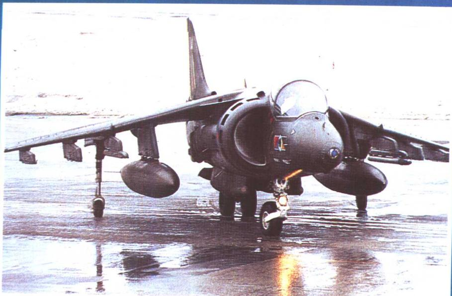
**美国 AV-8B“鹞”垂直起落战斗机** 原型机首飞于1966年。主要用于近距离空中支援特别是低空对地攻击，也可执行区域防空和战术侦察任务，可悬停。乘员1人，机长14.12米，翼展9.25米，机高3.55米，空重5936公斤。最大速度M0.91，实用升限15000米，转场航程3929公里，作战半径167~889公里。主要设备有火控雷达、角速率轰炸系统、环状激光陀螺系统等。武器装备有：2门25毫米8管机炮，7个外挂点，可挂空空、空地、空舰导弹，以及各种炸弹、火箭等。
