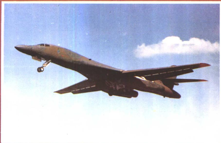
**美国 B-1B 变后掠翼轰炸机** 首飞于 1984 年，主要任务是实施远程战略轰炸。乘员 4 人，机长 44.81 米，翼展 41.67 米，机高 10.36 米，空重 87090 公斤。最大速度 M1.25，实用升限 15000 米，最大航程 12000 公里，作战半径 4800 公里。主要设备有多功能相控阵雷达、防御电子系统、惯导系统、多普勒速度传感器等。武器装备有：3 个武器舱和 8 个外挂点，可带巡航导弹、近距攻击导弹、核弹、常规炸弹等。
