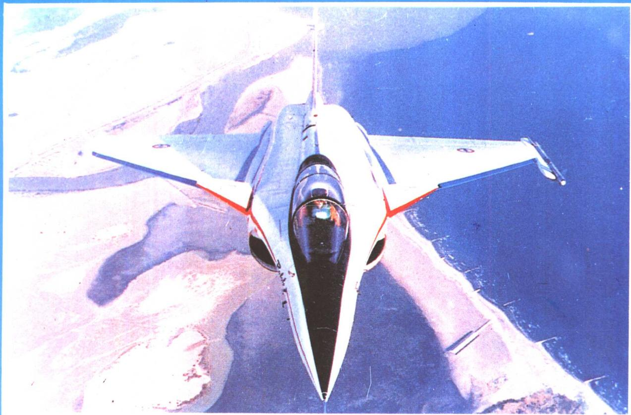
**法国“阵风”实验战斗机** 法国正在研制中的下一代战斗机,计划 1996 年开始装备部队。乘员 1 人,机长 15.30 米,翼展 10.90 米,机高 5.34 米,空重 9400~9500 公斤。最大速度 2120 公里/小时,作战半径 480~800 公里。主要设备有航空电子设备、先进的通信、导航和座舱显示设备等。武器装备有:1 门航炮,14 个挂架,可挂空空导弹及其他多种武器。
