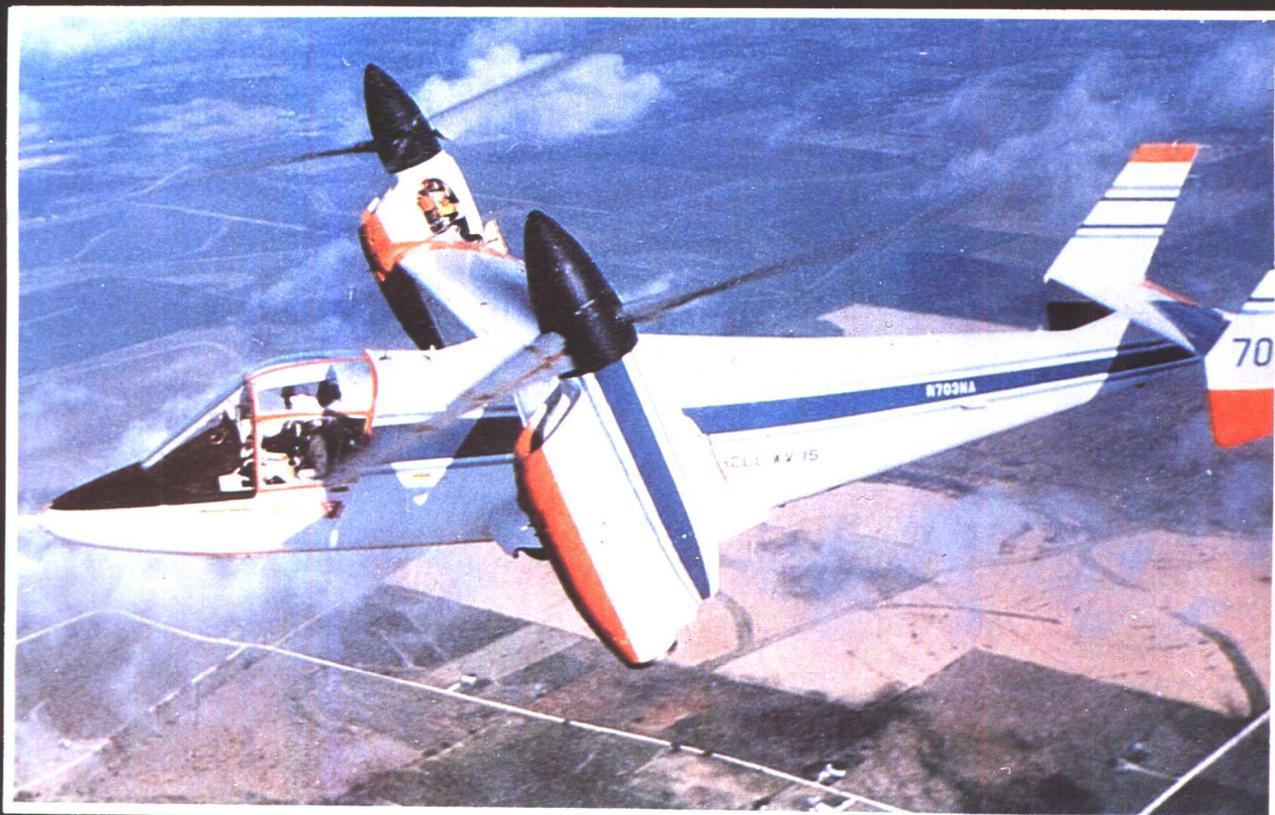
**美国 XV-15 倾转旋翼实验机** 该机两个发动机短舱装于两翼尖，可向上倾转，与翼面垂直时呈直升机型式，转到水平时呈固定翼飞行式。乘员 2 人（驾驶舱可乘 9 人），旋翼直径 7.62 米，翼展 10.72 米，机长 12.83 米，机宽 17.42 米，空重 4341 公斤，最大有效载荷 1542 公斤。最大速度 615 公里/小时，最大爬升率 16 米/秒，实用升限 8840 米，航程 824 公里。机载设备有：增稳控制系统，甚高频、超高频电台，伏尔仪表着陆系统，指点标接收机和测距设备，以及盲目飞行仪表等。
