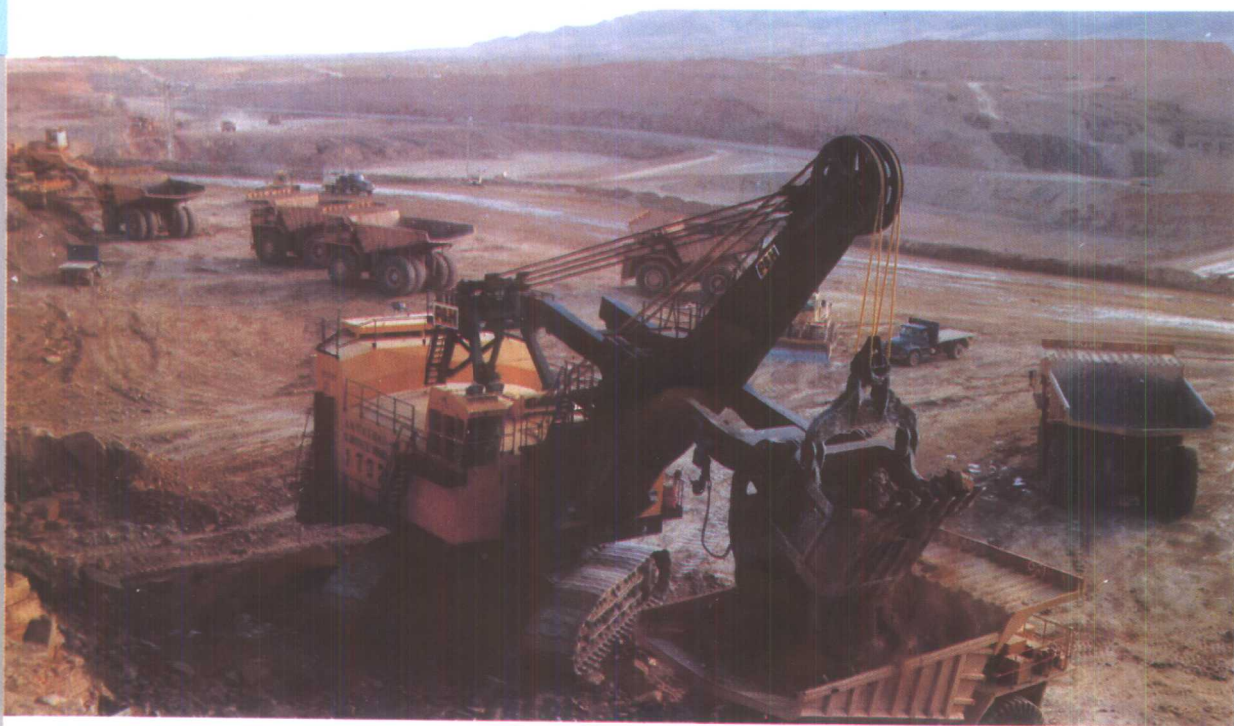
斗容 25 立方米的大型电铲和载重 154 吨的 170 型汽车在平朔安太堡露天煤矿进行剥离作业
