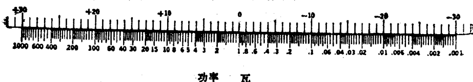
图1-6 直接求功率比分贝数值的诺模图。
