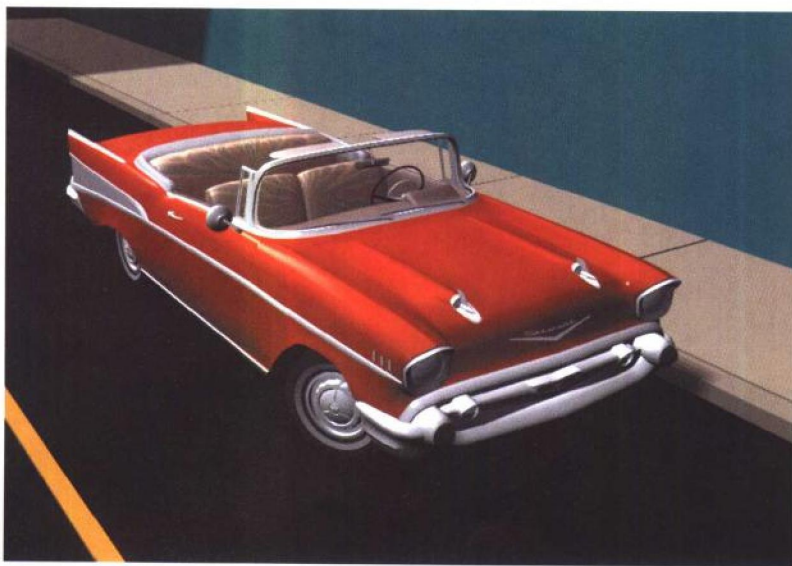
彩图 2 如果您想试验 AutoCAD 的渲染效果,可以打开 AutoCAD 的 Sample 目录底下的 Chevy.dwg 文件,按已经设置好的参数渲染。如果还嫌效果不够好,而且不嫌速度慢的话,可以在 Render 对话框中单击 Options 按钮,然后在 Anti - Aliasing 参数区中选择 High 选项,再次执行 Render 命令。现在您应该相信 AutoCAD 的渲染能力了。
