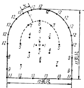
图 1-6 地下巷道典型段发顺序布置 (注: 图中Y比X大)
