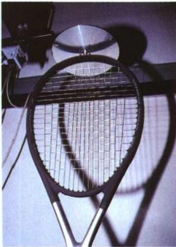
球拍架正在接受检测。超高强度的金属钛同非常之轻的高模量的碳纤维被编织在一起，组成了一副异常坚固强壮、可以防止扭动的框架。
