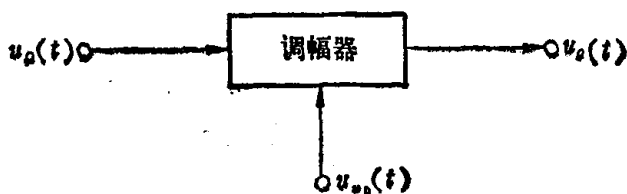
图 1.1 调幅器的一般框图
