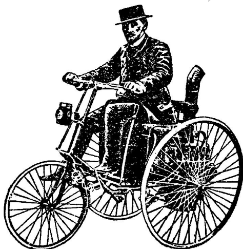
图1.5 Serpollet的烧煤蒸汽三轮车(引自[1.3])
