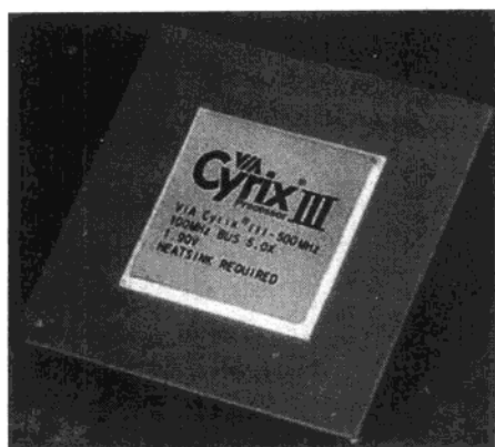
图 2-2 CPU 的表面上标有它的主频
