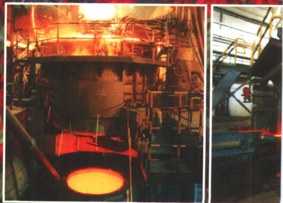
从意大利引进的 70 吨超高功率电炉
