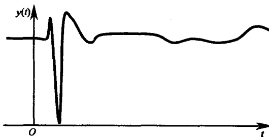
图 1-6 滤除了干扰的心电信号
