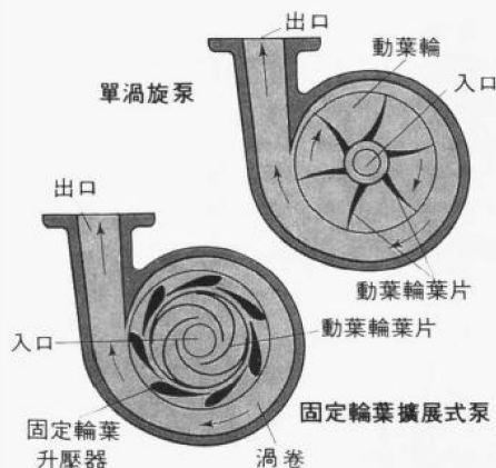
圖6. 單渦旋泵及固定輪葉擴展式泵 兩者內之流體離開動葉輪後流經漸次擴大的渦旋機殼，將流體的壓力增加。
