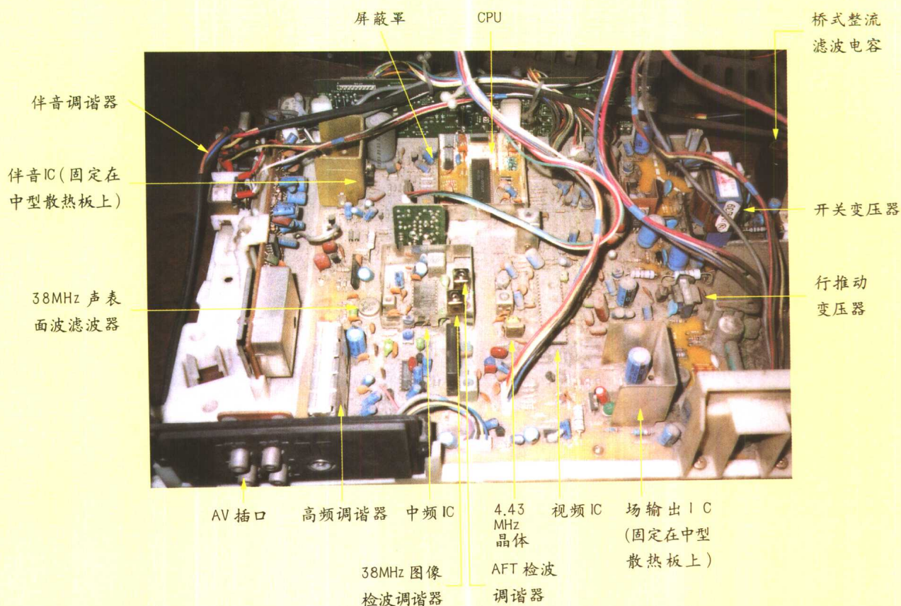
彩图 13 主要易损元器件在主机板上的位置识别
