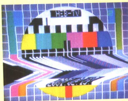
(a) 38MHz 频率失谐造成的图像效果差
