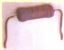
(a) 场供电保险电阻
