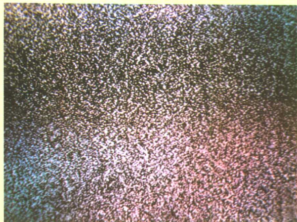
(b) 着磁光栅(整体颜色不一致,局部有彩斑)
