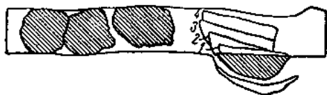
图 3 玻璃颗粒在水中运动的摄影分析图(88 号胶片)
