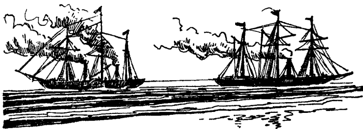
图4 螺旋桨船(右)与明轮船(左)比赛
