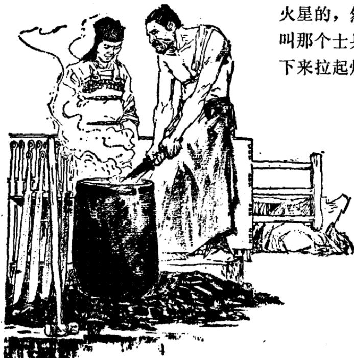
的风箱。不一会儿，炉膛中的火越烧越旺。蒲元又添些炭块，将熟铁放在炉膛中煅烧，烧得炽热红透后，再把它取出放在铁砧上。蒲元抡起大锤“叮当”“叮当”地打起来。他一会儿烧，一会儿打，“一次、二次、三次……”蒲元默默地记着锻打的次数，最后，他将打成的刀再放在炭火中烧，烧得红透时，一下子放入旁边的水缸里。顷刻，水缸冒出一股热气，缸里“咕咕”地直冒气泡。蒲元仔细地观察着热气和气泡，自言自语地说：“看来是水的问题。”等了一会，蒲元将冷却了的刀取出来，然后俯下身子，用手搅了搅缸中的水。只见水缸里泛起了一些黄色的泥沙。
