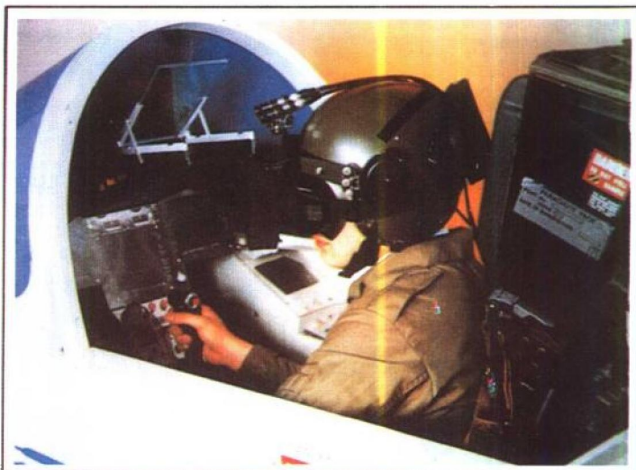
► 图 4 不列颠 Aerospace 在真实机舱中装设的虚拟环境可设置式飞行训练辅助器
