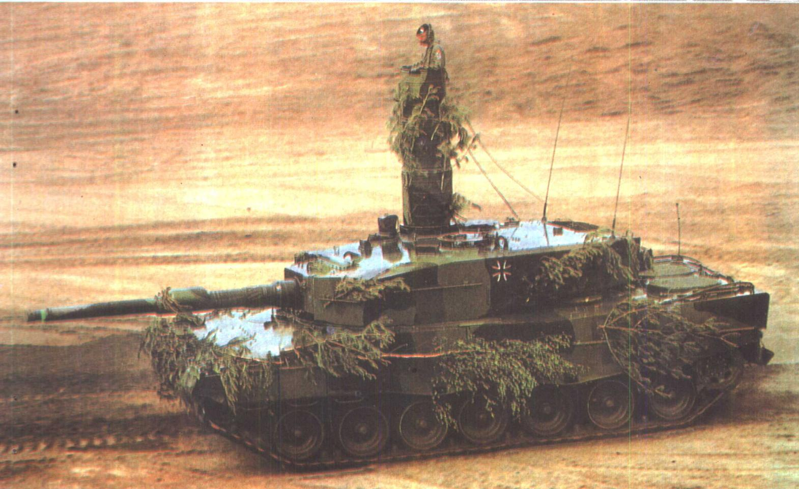
“豹”2主战坦克，战斗全重 55.15 吨，乘员 4 人，主要武器为 1 门 120 毫米滑膛炮，辅助武器为 1 挺 7.62 毫米并列机枪，1 挺 7.62 毫米高射机枪，最大速度 72 公里/小时，最大行程 550 公里，有三防装置。
