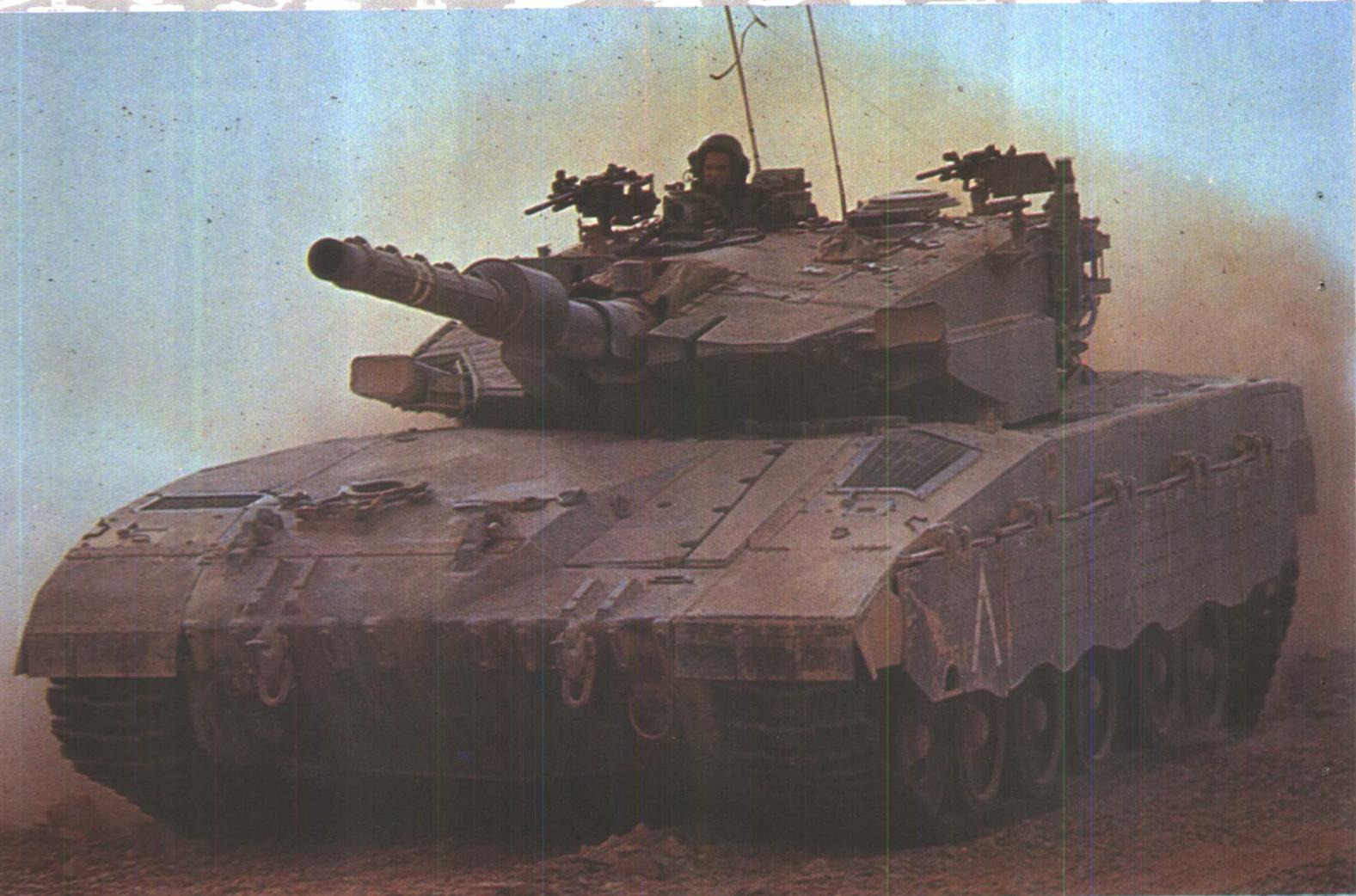
“梅卡瓦”主战坦克战斗全重 60 吨，乘员 4 人，主要武器为 1 门 105 毫米线膛炮，辅助武器为 1 门 60 毫米迫击炮，3 挺 7.62 毫米机枪。最大速度 58 公里/小时，最大行程 500 公里，有三防装置。
