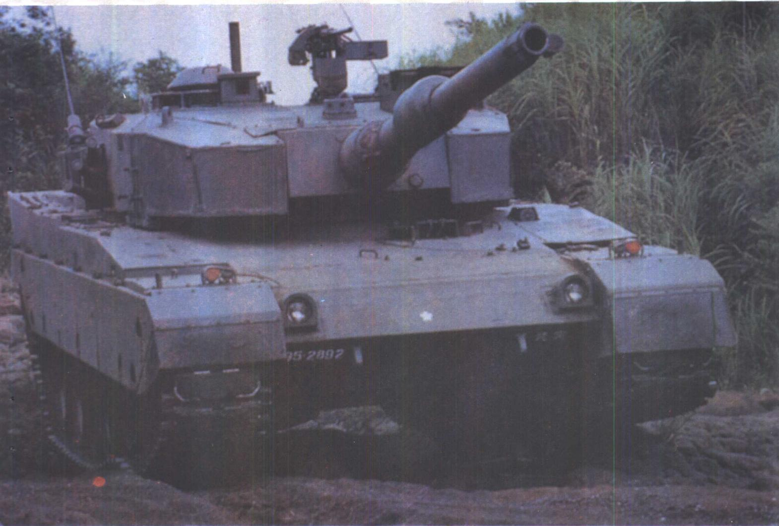
90 式坦克是日本新研制的主战坦克，战斗全重 60 吨，乘员 3 人，主要武器为 1 门 120 毫米滑膛炮，辅助武器为 1 挺 7.62 毫米并列机枪和 1 挺 12.7 毫米高射机枪，最大速度 70 公里 / 小时，最大行程 300 公里，有三防装置。
