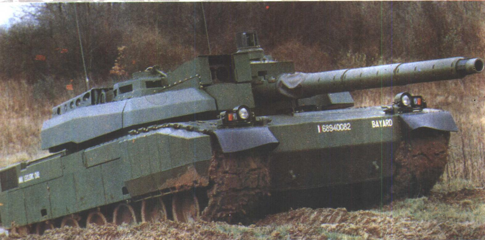
“勒克莱尔”是法国最新研制的主战坦克，战斗全重 53 吨，乘员 3 人，主要武器为 1 门 120 毫米滑膛炮，辅助武器为 1 挺 12.7 毫米并列机枪和 1 挺 7.62 毫米高射机枪，最大速度 70 公里 / 小时，最大行程 550 公里，有三防装置。
