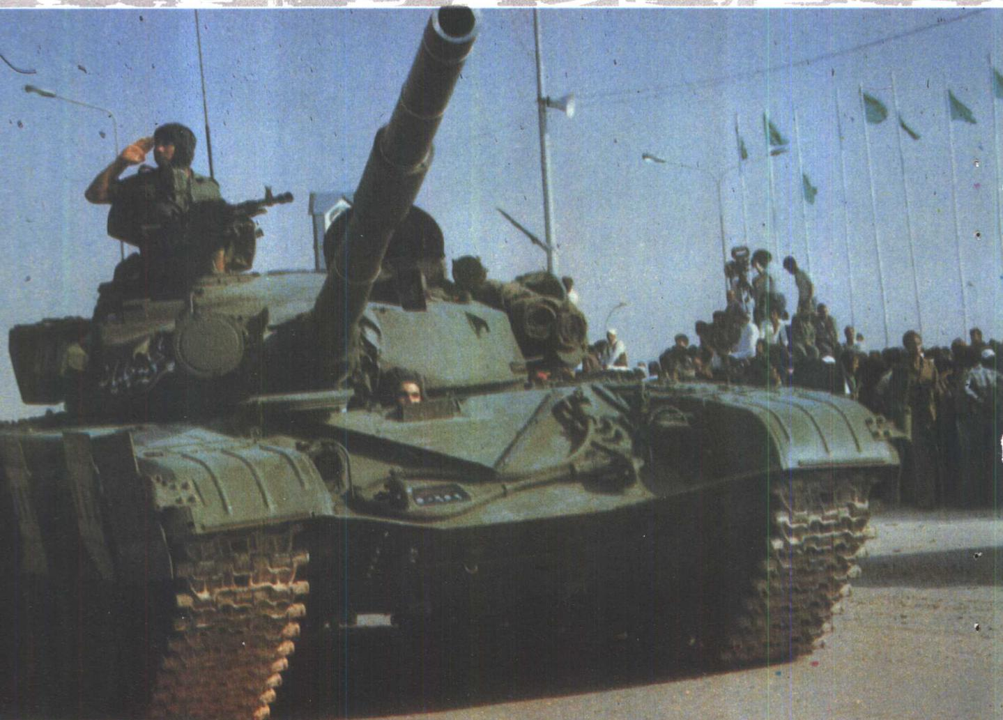
该车战斗全重 41 吨，乘员 3 人，主要武器为 1 门 125 毫米滑膛炮，辅助武器为 1 挺 7.62 毫米并列机枪和 1 挺 12.7 毫米高射机枪。最大速度 60 公里 / 小时，最大行程 500 公里，有三防装置。
