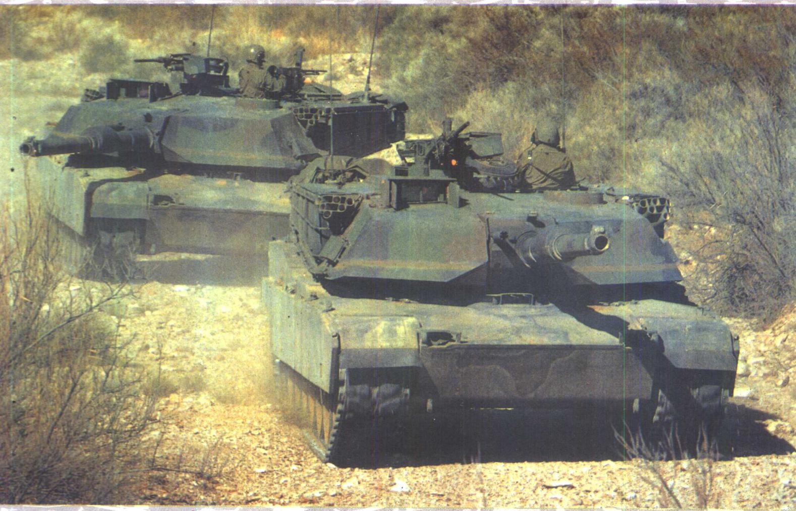
M1A2 是美国正在改进的第三代主战坦克，战斗全重 62.5 吨，乘员 4 人，主要武器为 120 毫米滑膛炮，火控系统有多种运算功能，使火炮能自动跟踪目标。最大速度 67 公里/小时，最大行程 465 公里。有三防装置（防核子、生物、化学武器）。
