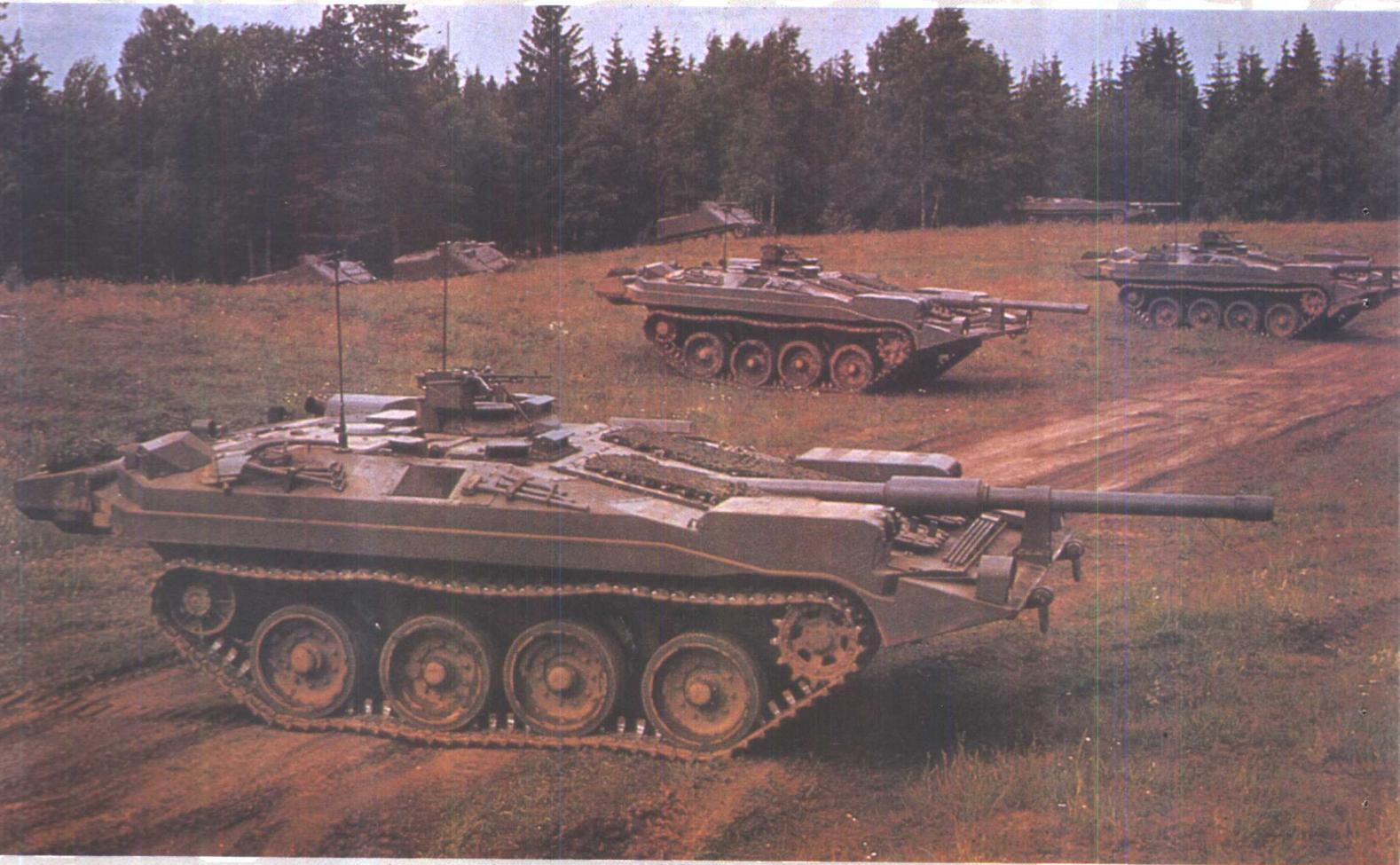
Strv 103 是世界上唯一的无炮塔主战坦克，战斗全重 39.7 吨，乘员 3 人，主要武器为 1 门 105 毫米线膛炮，辅助武器有 2 挺 7.62 毫米机枪，1 挺 12.7 毫米高射机枪，最大速度 50 公里/小时，最大行程 340 公里，无三防装置。
