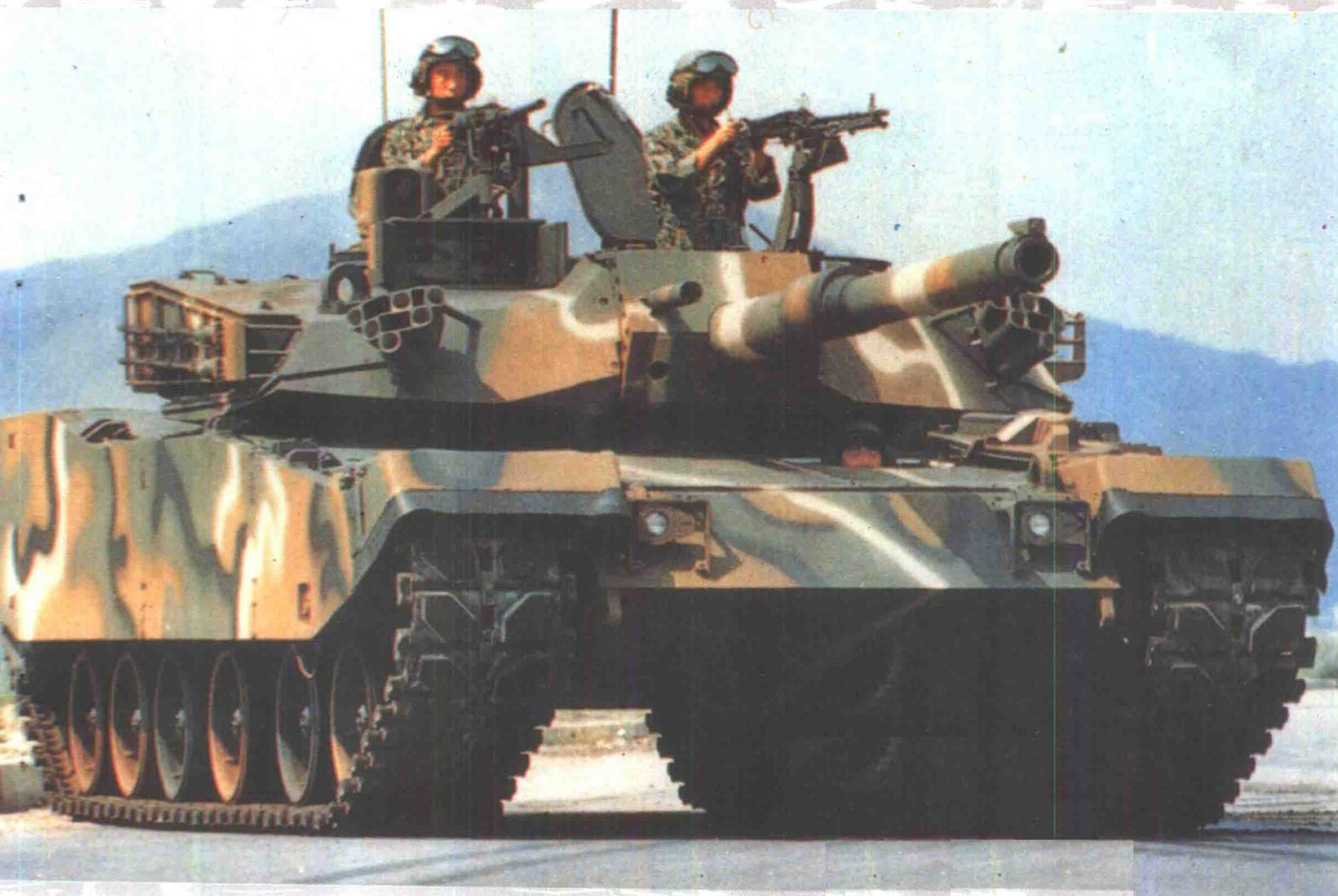
该车战斗全重 51 吨，乘员 4 人，主要武器为 1 门 105 毫米线膛炮，辅助武器为 2 挺 7.62 毫米机枪，1 挺 12.7 毫米高射机枪。最大速度 65 公里/小时，最大行程 500 公里，有三防装置。
