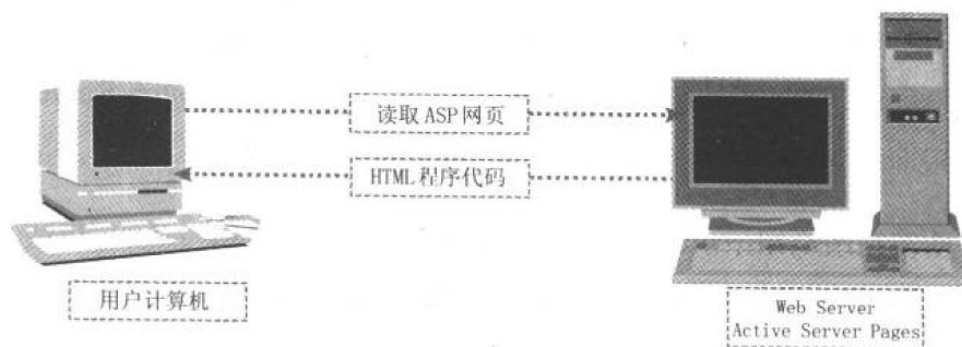
图1.4 服务器端处理 ASP 网页的示意图
