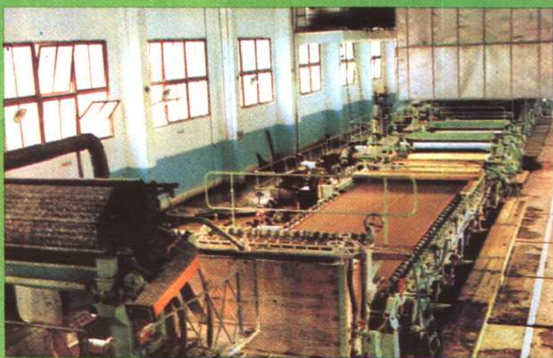
△宜宾造纸机械厂生产的BZG321型幅宽1880mm长 网造纸机
