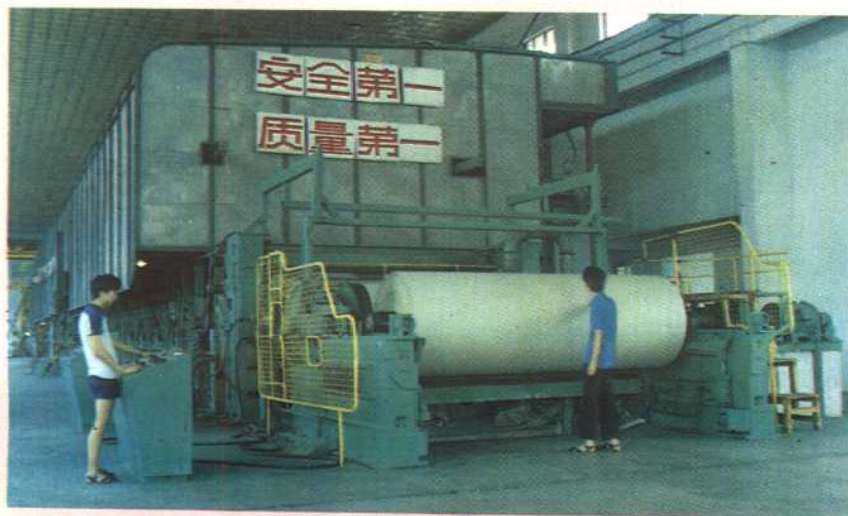
◁从瑞典引进 E55 幅宽 3300MM 日产 100 吨的全程造纸机由宜宾纸厂自行安装于 1987 年投产
