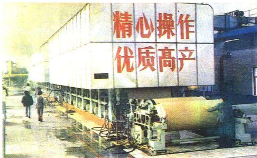
▷ 长江造纸厂伸性纸袋纸，幅宽2040MM 纸机一九八八年四月竣工投产
