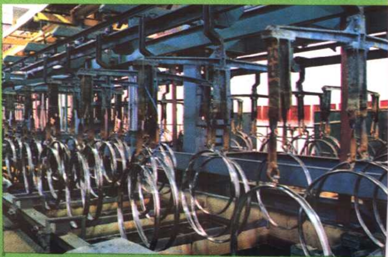
△成都峨嵋自行车厂车圈电镀生产线
