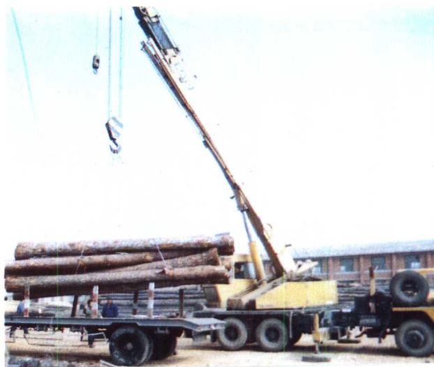
市搬运公司起重机 卸车作业
