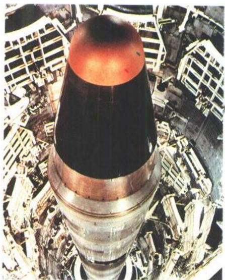
右图:大力神二型是美国第一种从掩体中发射的洲际弹道导弹,并有可承受 21\text{kg}/\text{cm}^2 压力的掩体保护。
