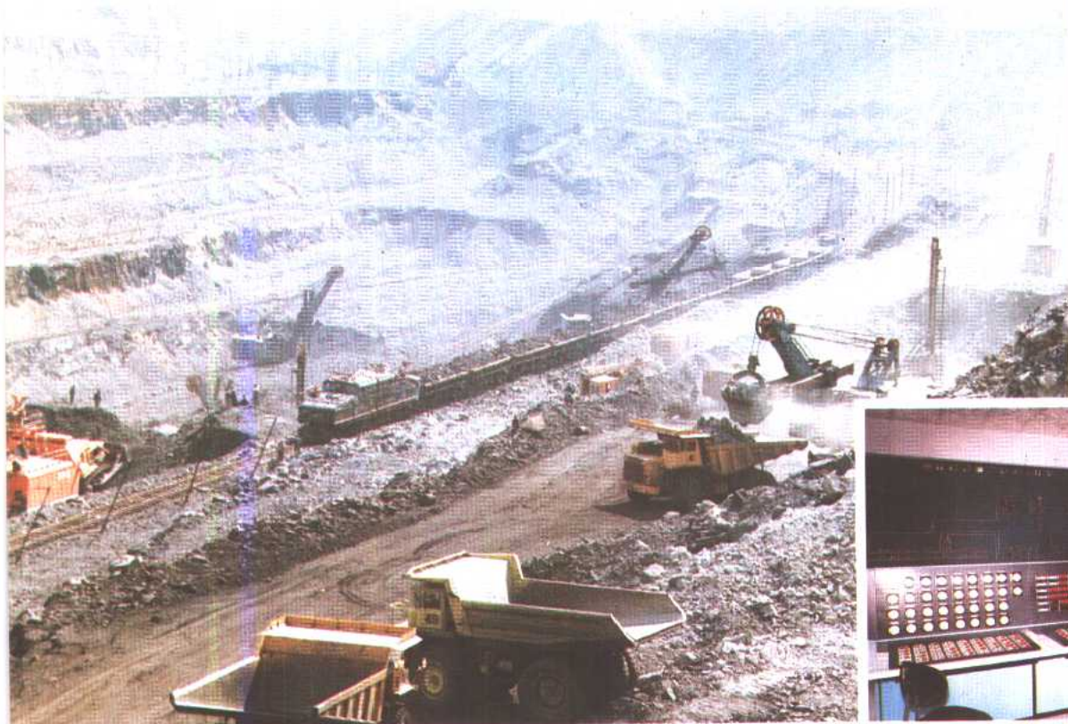
抚顺矿务局西露天矿实行分区开采、内部排土、联合运输技术改造中的采煤现场。
