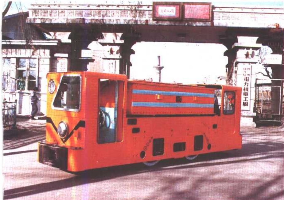
抚顺矿务局电力机车厂研制的CXTS—8型矿用8吨双司机室防爆特殊型蓄电池电机车。
