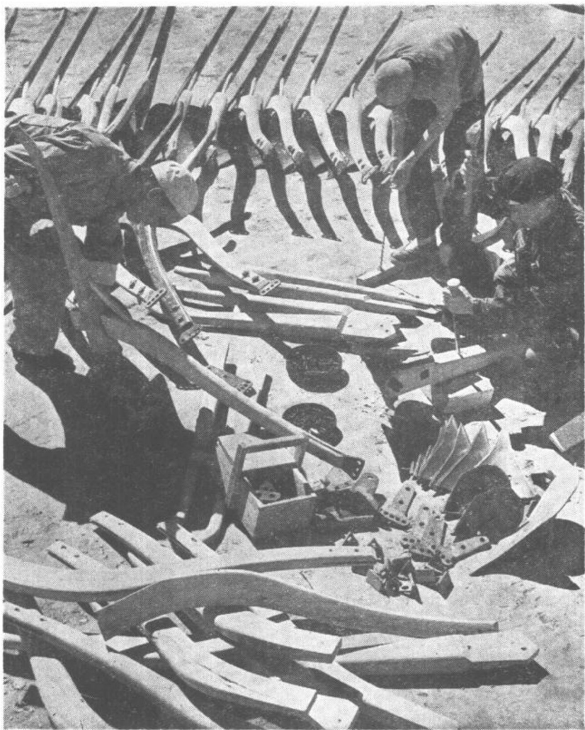
县农具制造厂的工人，正在制做适合山地使用的山地步犁
