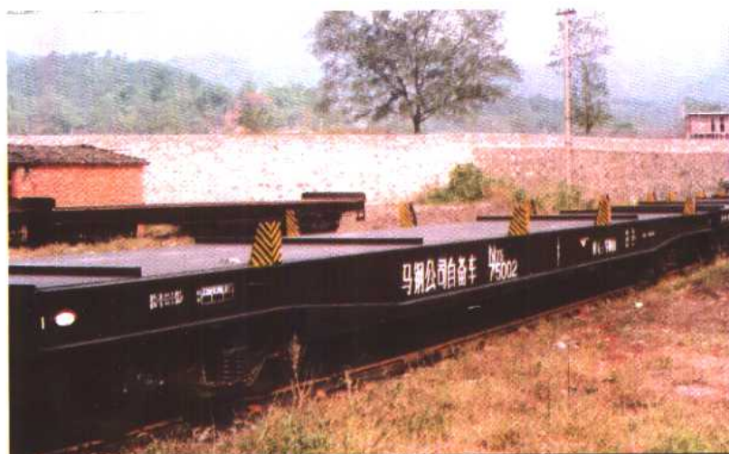
铁道部铜陵机车工厂为马钢 公司设计制造的 75 吨铁地板平车
