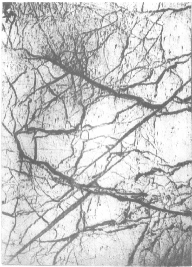
5 树枝状裂纹 (煤光片)
