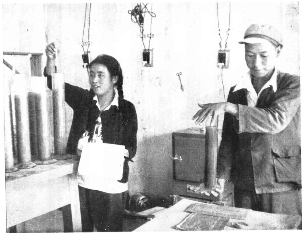
技術人員在作泥沙顆粒分析試驗，以求 得水庫內泥沙淤積和運行的規律。
