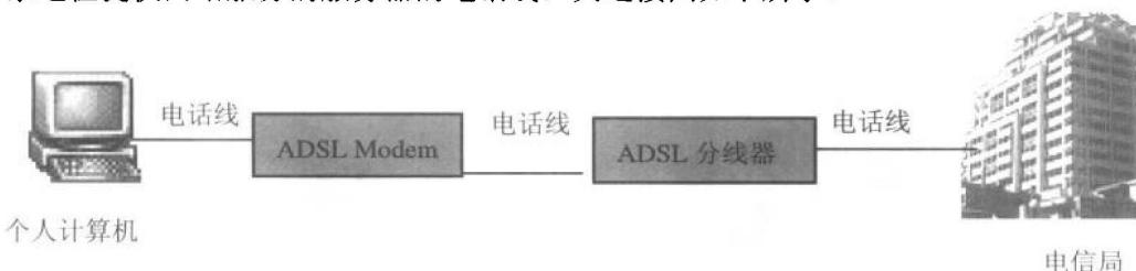
使用 ADSL 方式上网，优点是速度比使用传统调制解调器拨号上网快，缺点是若用户离电信局较远，将无法申请 ADSL 服务（一般为 4km 以内）。
