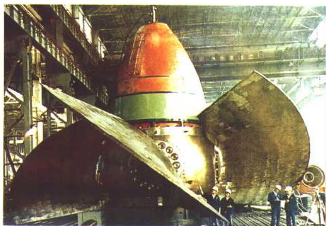
东方电机厂研制的目前 世界上尺寸最大的轴流转浆 式机组——葛洲坝170MW机 组转轮预装现场。获1985年 国家科技进步特等奖
