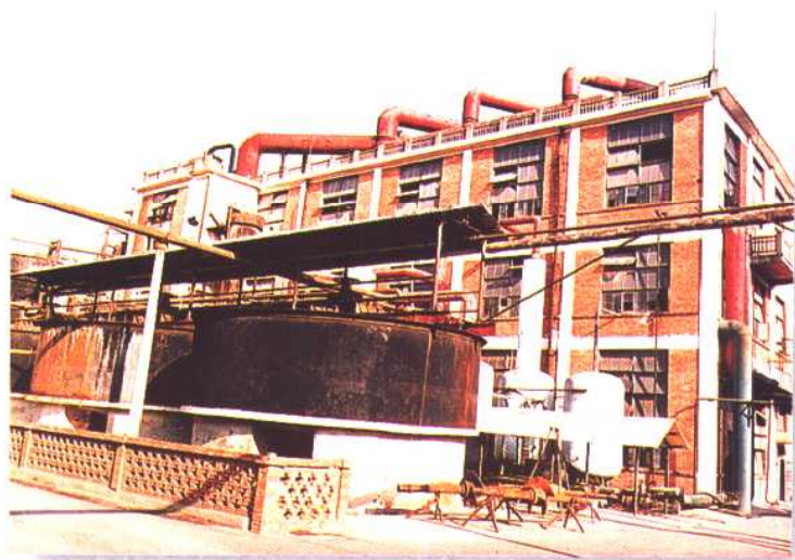
我国最早的真空制盐—— 张家坝化工厂真空技术制盐年产10万吨装置
