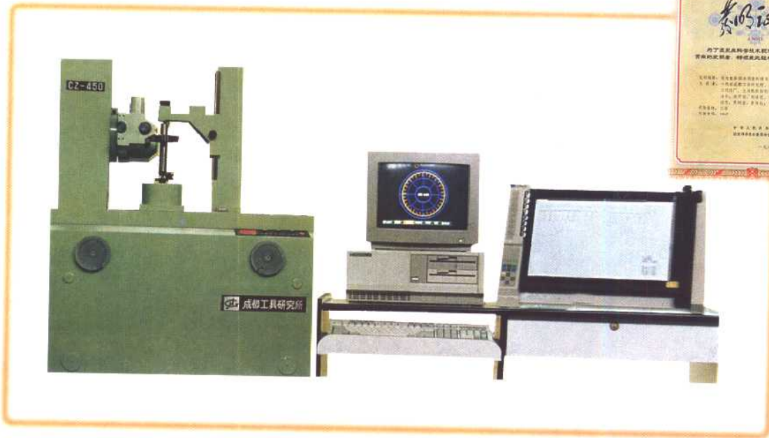
荣获1980年度国家发明二等奖的圆柱齿轮单面啮合整体误差测量技术
