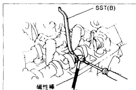
注意：若 1 号轴承盖配合得不好，则用改锥撬动分开气缸盖与凸轮轴齿轮，将凸轮轴齿轮向后推。
