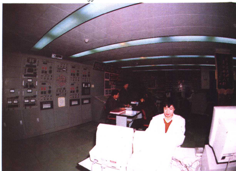
34 清华大学创建的我国第一套核电厂模拟培训机
