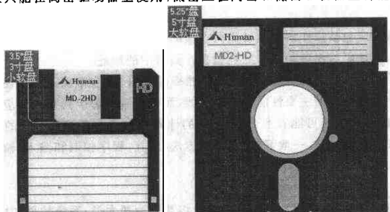
图 1.2.5 5.25 英寸和 3.5 英寸软盘示意图
