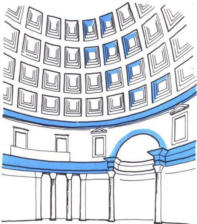
► 简单的结构比例使万神殿的内部显得既和谐又宏伟：大殿的高度和拱顶的直径相同；拱顶是从内墙的中间向上砌成的。光线是从一个8.74米宽的单一圆形屋顶天窗射进来的。这座用砖砌面水泥建造的精巧建筑为丰富多采的装饰品所掩盖起来。装饰品中有许多是希腊式的。下面的壁龛装饰着圆柱、壁柱和科林斯式柱顶盘。
