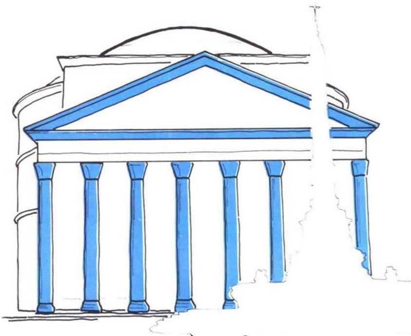
▲ 罗马人对希腊建筑传统的尊重使他们在可能的范围内使自己的庙宇看起来同希腊庙宇一样。即使在形式和使用材料方面完全不同。这类建筑物的突出特点是建有一个有着山形屋顶的深柱廊。这幅图展示了这种式样的庙宇的正面结构——共有八个圆柱，每个柱子都有柱基和柱头，还有巨大的三角形墙或山形墙。然而位于门廊后面的大殿(pronaos)却是用意大利水泥建造的。
