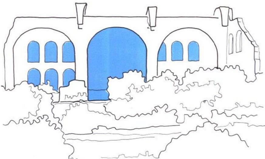
▲ 罗马人逐步发展其使用砖砌面混凝土的技能，直至他们能够用这种材料建造宏伟建筑物。通常，这类建筑物有半圆形（而且往往是交叉的）拱顶状（如图所示）或者半球形圆顶状的混凝土屋顶。正如图中的窗孔那样，那些形状重复的建筑结构显示出建造者有效利用木材和劳力的能力。建造者用同一个木拱架，在水泥凝固后把它向前移动。
