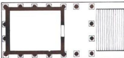
◀ 古罗马庙宇通常 是长方形的而且建在一 座平台上，庙宇中 建有一座宽大的正殿 （有时分成两个或三 个室），用来供奉神 像。用砖瓦覆盖的屋 顶两端各筑有一堵山 形墙或三角墙。门厅 圆柱的装饰在大厅的 周围及后面以半露柱 或壁柱形式再现。这 是大殿的背 面示 意图。在庙宇的正面还 铺有一段阶梯（没有 示出），祭坛设立在 大殿前面的露天广场 上。
