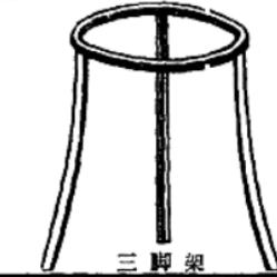
三 脚 架 | 铁制品，有大小、高低之分，比较牢固。   | 放置较大或较重的加热容器。                   |                     |
