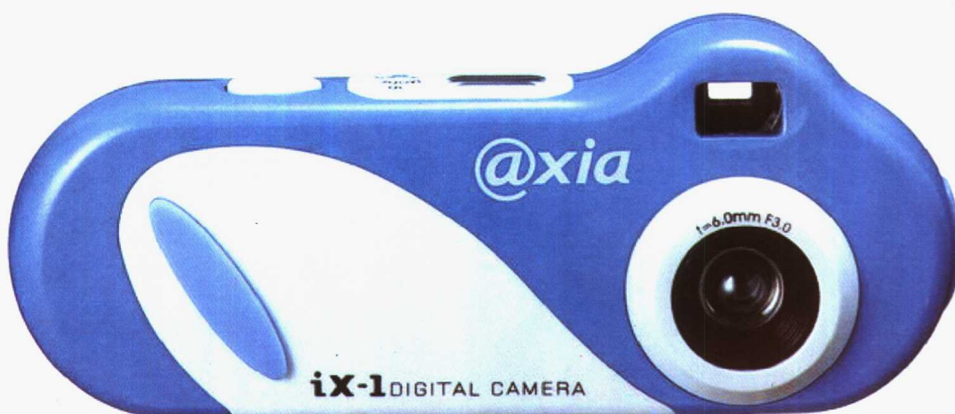
富士于2001年11月推出的@xia ix-1数码相机，采用CMOS传感器， 重量只有96克，是VGA（640 × 480像素）级网络型时尚机型
