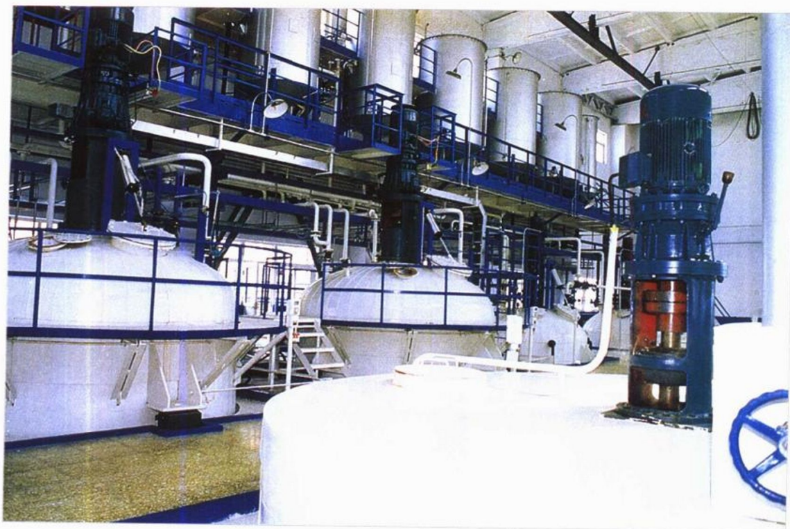
6. 齐鲁石化公司催化剂厂NaY分子筛大型化合成装置。该装置应用了大型化合成设备、高效机械搅拌系统、动态快速混合升温、电伴热和新型保温材料、新型仪表控制系统和动态电子称计量等多项新技术。该装置的建成投产提高了NaY分子筛生产的技术水平和质量，降低了生产成本，提高了装置的自动化水平，实现了大型化、集约化生产，提高了NaY分子筛的质量和经济效益。
