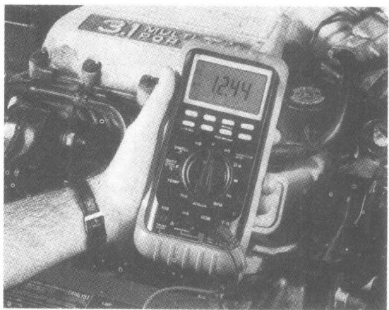
图 1-8 如有源搭铁线路测得的电压降大于 0.1V, 则应检查一下接头
