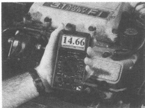
图 1-1 确保充电系统给蓄电池提供的电压不小于 13.5V
