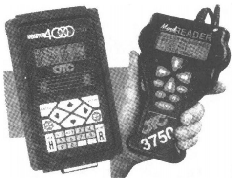
图 1-7 连接解码器, 查取故障码, 确定检测结果
