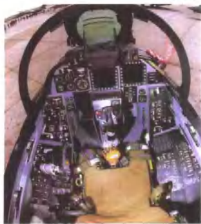
F-14D座舱采用新的武器管理、导航、显示和控制系统。
