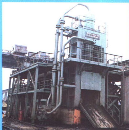
中日合作制造的1250 吨废钢液压剪切机
