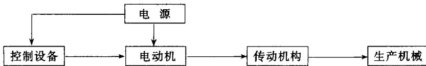
电动机把电能转换成机械能,通过传动机构把电动机的运动经过中间变速或变换运动方式后,再传给生产机械驱动生产机械工作(有些情况下,电动机直接拖动生产机械,而不需要传动机构)。生产机械是执行某一生产任务的机械设备,是电力拖动的对象。控制设备是由各种控制电机、电器、电子元件及控制计算机等组成,用以控制电动机的运动,从而对生产机械的运动实现自动控制。为了向电动机及电气控制设备供电,电源是不可缺少的部分。
