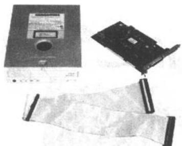
光盘存储器的最大特点是存储容量大，为几百兆字节，目前最大容量每张为 640MB；此外还具有价格低、寿命长、可靠性高等优点。光盘特别适用于需要存储容量大的电脑使用，例如，使用大型数据库、图像处理、语音识别或存储文件档案等。
