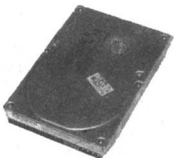
硬盘的发展较快。早期的 5.25 英寸软驱全高或半高硬盘一般只有 10~40MB 容量，这类硬盘一般使用 ST506 / 412 接口。它有两根连接电缆，一根为控制电缆，一根为数据电缆。另一种为 3.5 英寸软驱的 IDE 接口的硬盘，它只用一根 40 芯的电缆联接适配卡。其容量限制在 540MB 以内。一种扩展的 IDE 接口（称作 EIDE），其容量不受 540MB 的限制，其数据传输较 IDE 快。
