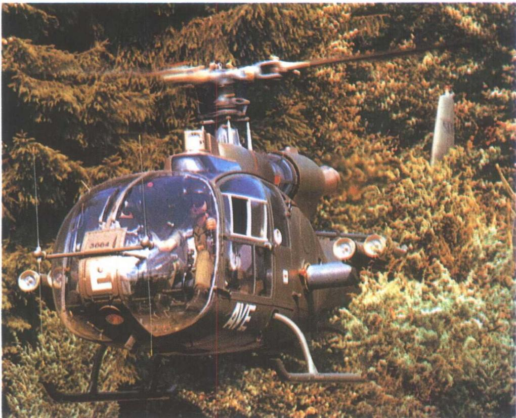
SA341/342 “小羚羊” 直升机是法国、英国共同研制的一种单旋翼轻型多用途直升机，主要用于反坦克和近距离支援，亦可执行侦察和联络任务。该机最大起飞重量2000公斤，最大巡航速度260公里/小时，航程710公里。装备2个火箭发射器、2枚空地导弹、6枚反坦克导弹、2挺7.62毫米机枪和1门GLAT20毫米机炮。在1982年以色列侵略黎巴嫩战争中，叙利亚的“小羚羊” 直升机发射“霍特” 导弹，摧毁了以军的7辆坦克，成为武装直升机反坦克的第一次大规模实战。
