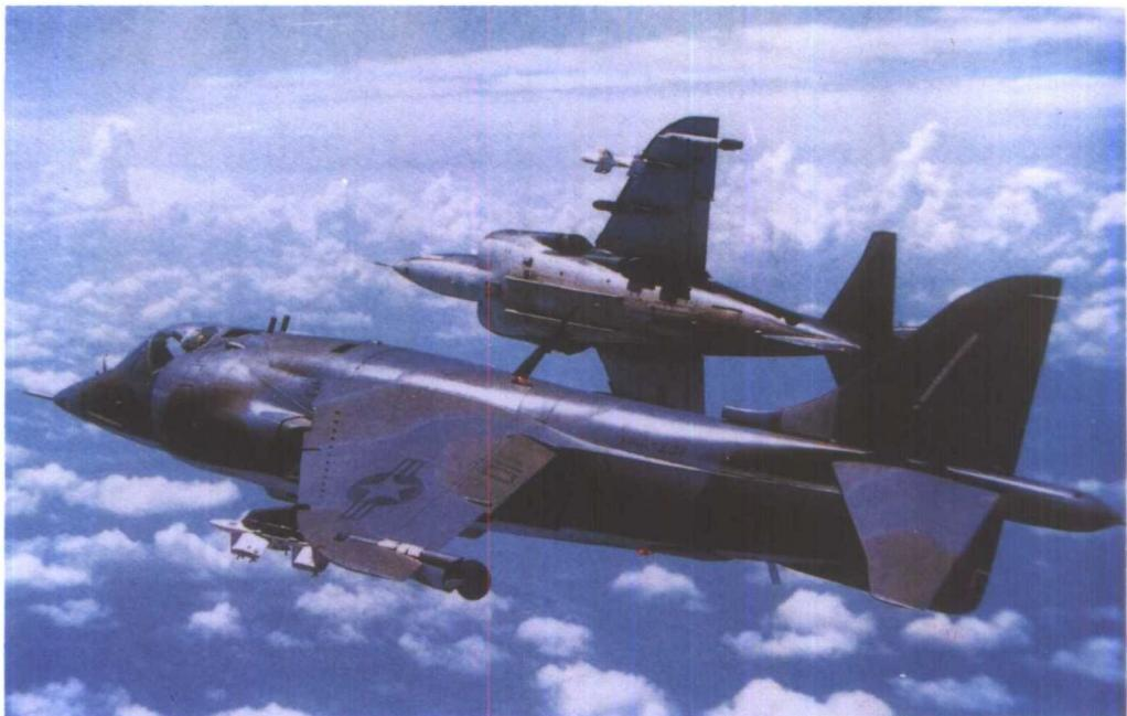
该机长14.12米，最大时速1160公里，航程3817公里。装备有两门20毫米机炮，外挂导弹、火箭、炸弹3.75吨。
