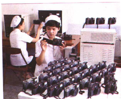
▲ 常州照相机总厂年产量占全国第二。红梅5型和红梅1型120照相机，名列全国第二、第三名。图为带闪光灯的新产品凤凰304型相机正在校验。
