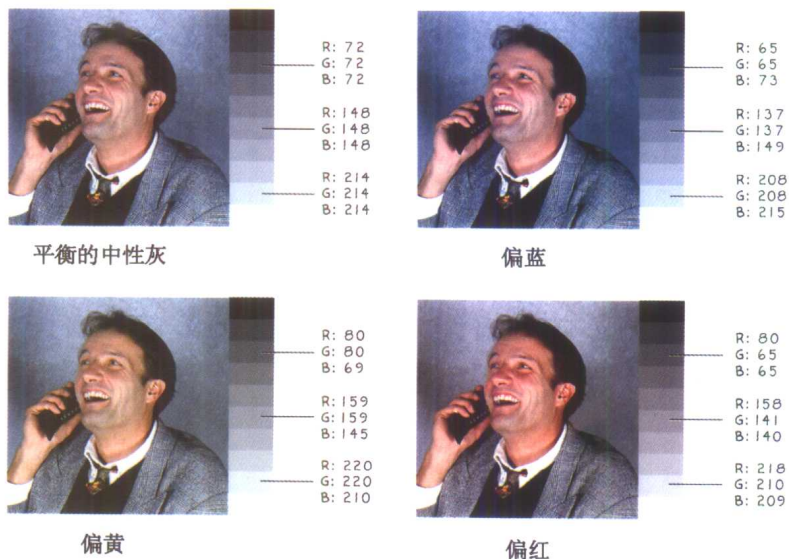
图 12.12 评估理应为中性灰的数值时，任何已有色偏立刻显现。为了更好地描绘偏色的效果，在每幅图像旁边加了一条灰梯尺
